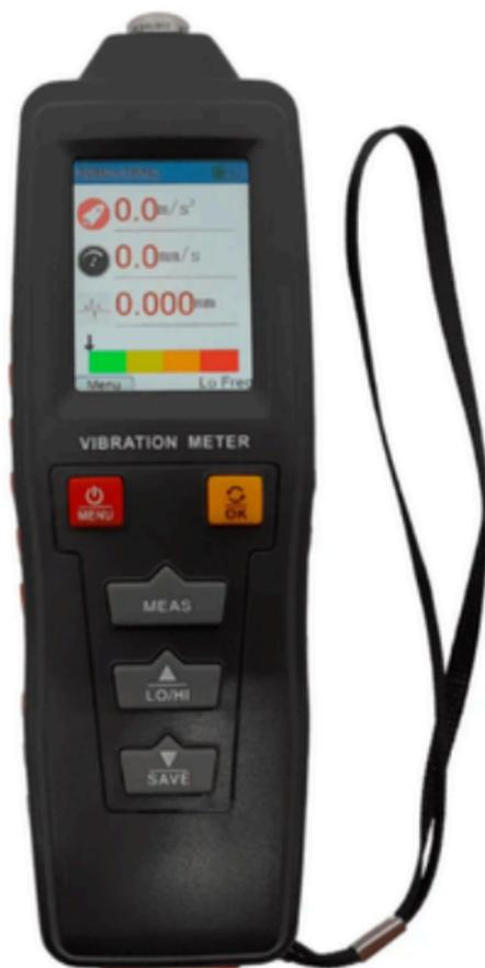
O Medidor de Vibração e Analisador IP-63B da Impac é uma ferramenta essencial, fundamentada no efeito piezoelétrico de cerâmicas polarizadas artificialmente. Este dispositivo é especialmente concebido para a medição precisa de vibrações em equipamentos mecânicos, destacando-se em máquinas rotativas e alternativas.
